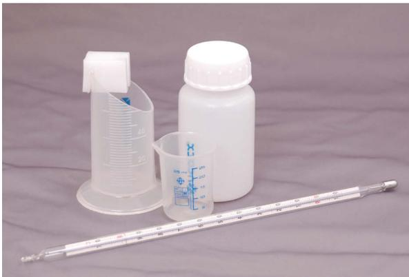
Молекулярное сито при погружении в воду выделяет тепло. Этот эффект лежит в основе метода определения качества молекулярных сит.
